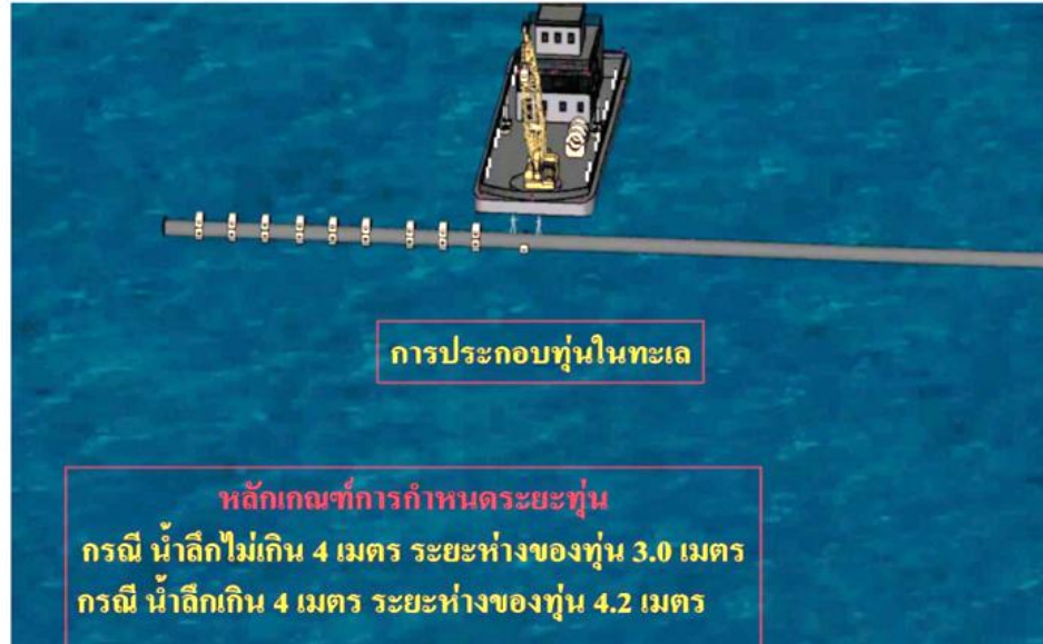
การเชื่อมต่อท่อในทะเลบน Barge -กรณีน้ำลึก < 15 m
